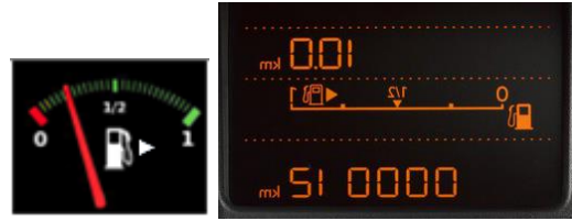
Indicador de nivel de combustible con flecha de depósito en el costado derecho
