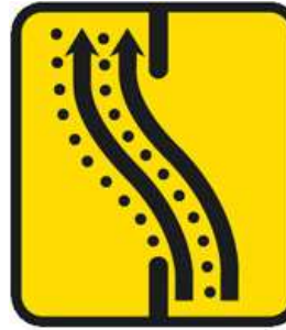
TS-62 Desvío de dos carriles por la calzada opuesta
