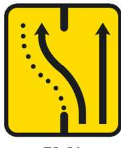
TS-61 Desvío de un carril por la calzada opuesta, manteniendo otro por la de obras
