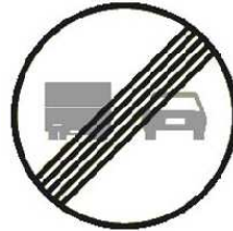
TR-503 Fin de prohibición de adelantamiento para camiones
